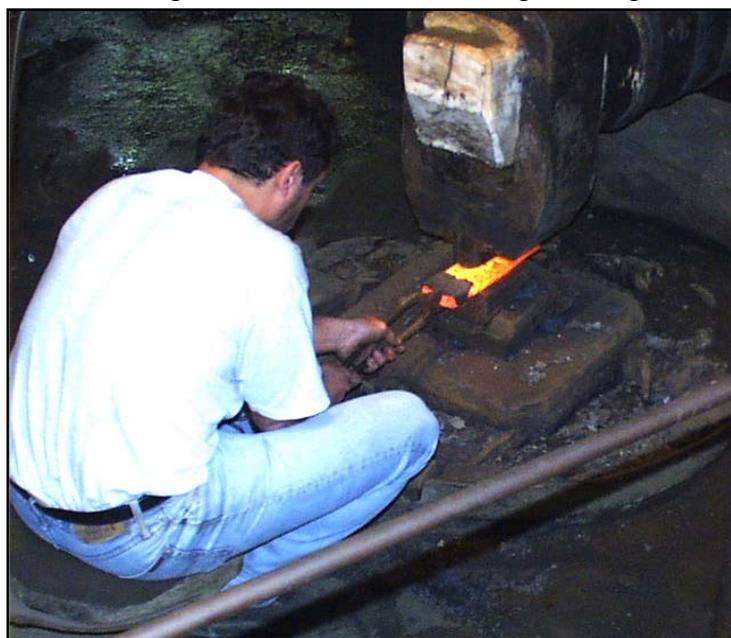
à la présence de minerai d'excellente qualité, de forêts pour la fabrication de charbon de bois et d'eau pour actionner les martinets et soufflets des forgerons. Le fonctionnement délicat du martinet a été décrit avec de nombreuses explications. La démonstration de forgeage d'une pièce de fer chauffé au rouge à l'aide d'un martinet antique actionné par une chute d'eau a été l'un des moments les plus forts de la journée. un spectacle unique... pour encore combien de temps?
